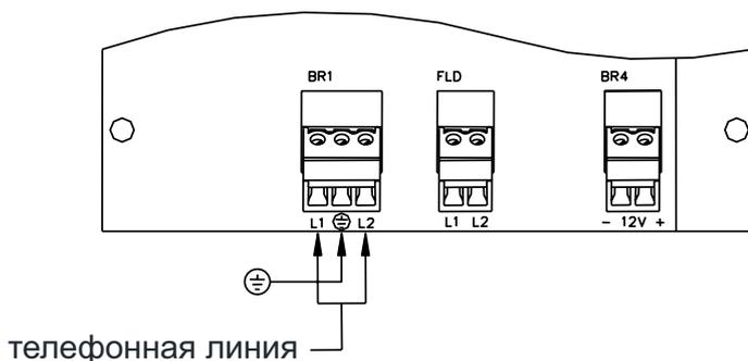
5. Подключите телефонную линию к клеммам L1 и L2 коннектора BR1 на плате телефона. Возможно подключение однопроводных и многопроводных проводов сечением до 1,5 мм<sup>2</sup>.
