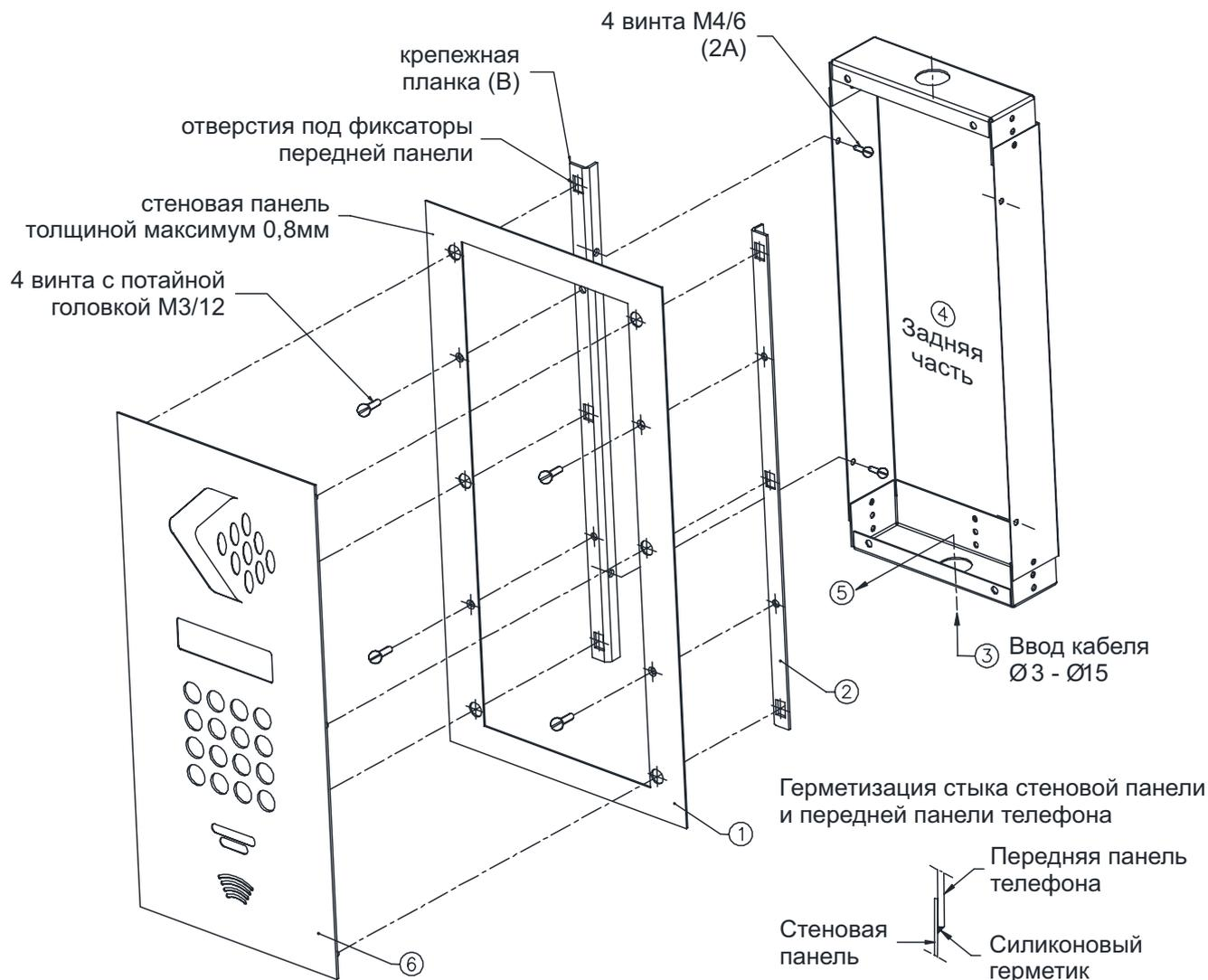
В настоящем разделе описан монтаж на стеновую панель с толщиной стенки до 0,8мм.
